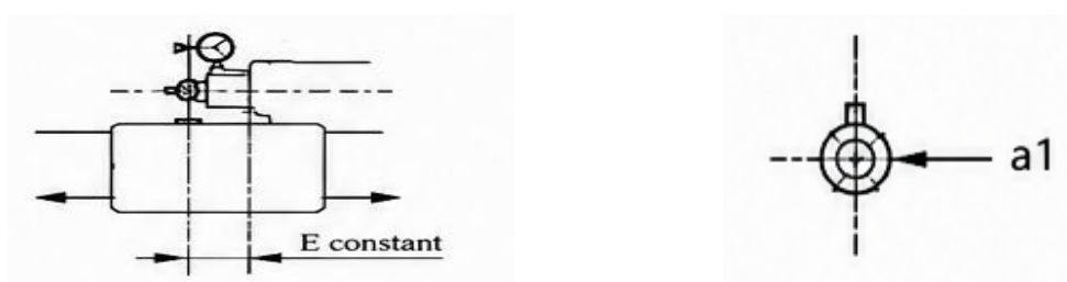
Gambar 5. Pemeriksaan Ketegaklurusan Gerak Eretan Melintang [12]
