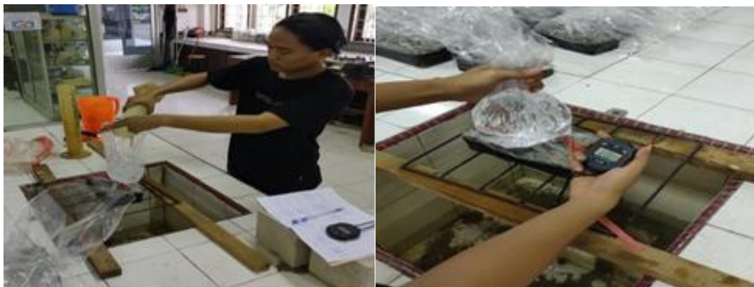
Gambar 6. Pengujian Laju Infiltrasi Benda Uji Paving Block
