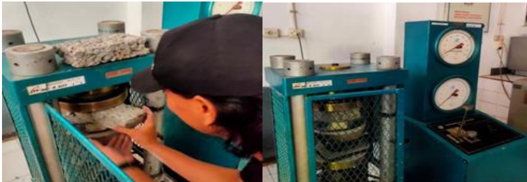
Gambar 5. Pengujian Kuat Tekan Benda Uji Paving Block
