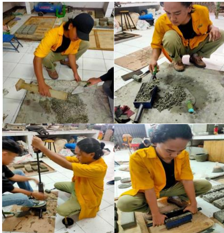
Gambar 3. Pembuatan Benda Uji Paving Block Berongga
