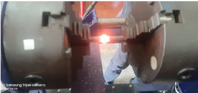
Gambar 7. Panas Yang Terjadi Pada Kedua Permukaan Material Uji Akibat Gesek
