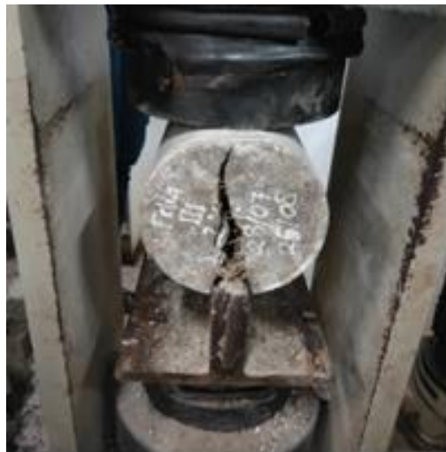
Gambar 8. Pengujian Kuat Tarik Belah Benda Uji Beton
