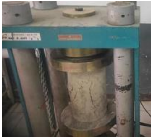
Gambar 7. Pengujian Kuat Tekan Benda Uji Beton
