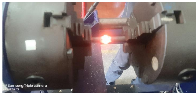
Gambar 3.1. Panas Yang Terjadi Pada Kedua Permukaan Material Uji Akibat Gesek
